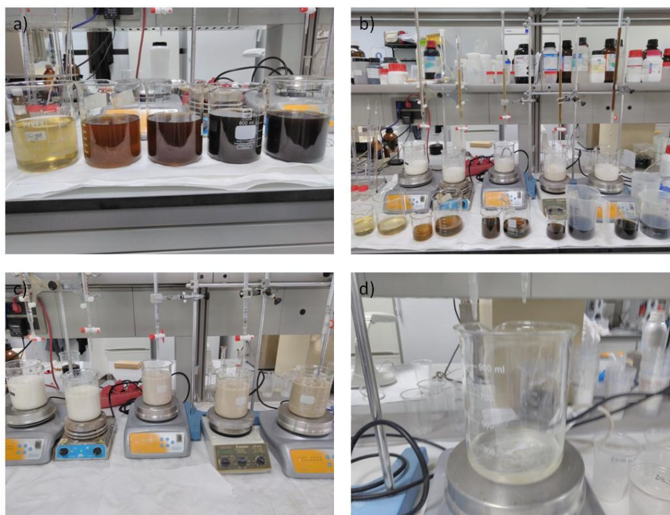
Figura 3. a, b, c) Fotografías del proceso de escalado de 10 g de catalizador (TiO 2 -GO) para diferentes contenidos de GO (0.1 %, 0.5 %, 1 %, 2 % y 5 % de GO). d) Proceso de escalado de 10 g de TiO 2 .
